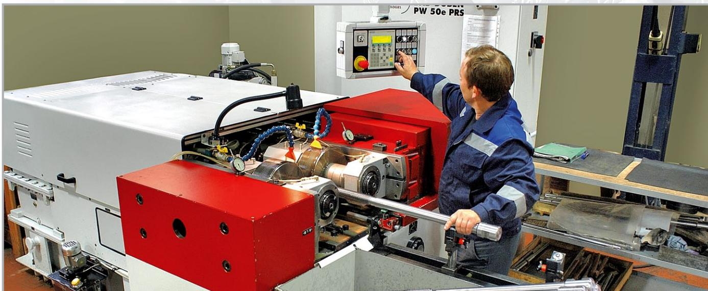
В IV кв. 2007 г. введен в эксплуатацию новый резьбопрофиленакатной станок германской фирмы **PROFIROLL PW 50e PRS** с максимальным усилием накатки 500 кН и диаметром обрабатываемых заготовок 10-120 мм.
