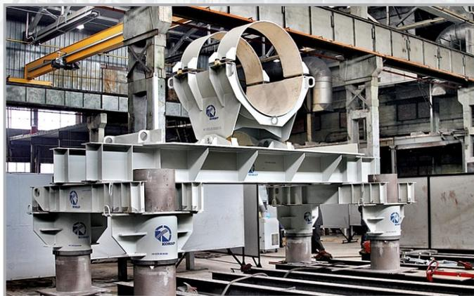
**Опоры для трубопроводов** обеспечивают защиту нефте- и газопровода и оборудования, к которому он присоединяется, от весовой нагрузки и препятствуют температурному расширению, поэтому они воспринимают не только весовую нагрузку, но и нагрузку от компенсации температурных расширений.
